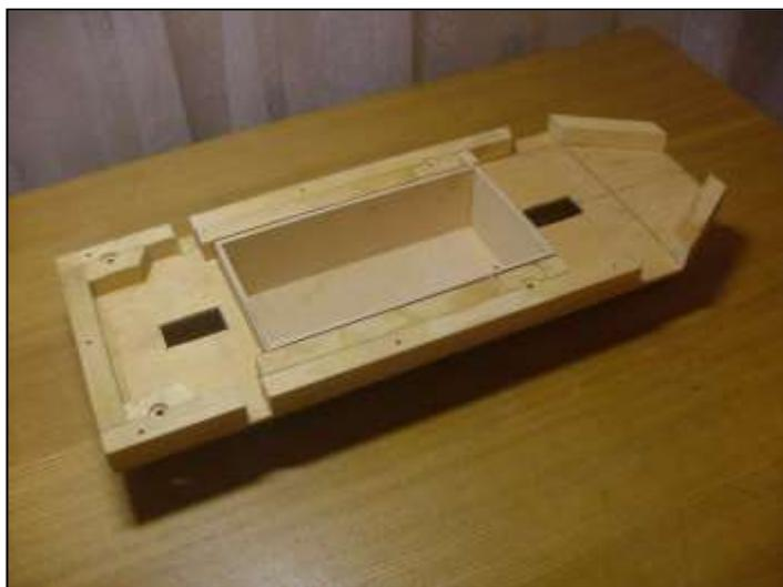
Платформа-носитель состоит из четырёхугольной деревянной рамы, обшитой 3-мм фанерой. На АПВ рама может быть сварена или склёпана из прочного дюралюминия. В раму вмонтированы стойки шасси, которые имеют двойную пружинную амортизацию – «вверх-вниз» (пружины работают на сжатие) и «вправо-влево» (пружины работают на растяжение).
