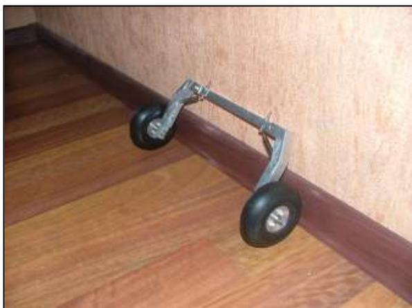
Стойки шасси изготовлены из алюминиевого профиля 15x15мм. Диаметр передних колёс «дутьшей» 90мм, задних 114мм. На АПВ предпочтительнее установить колёса «баллонного» типа и большого размера с функцией
