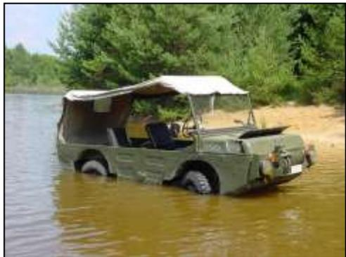
В 1961 году Луцкие инженеры начали производство ЛуАЗ 967 который был разработан совместно с конструкторами НАМИ придумавшими БТР 152 и НАМИ 049 на автомобиле использовались стальной кузов с мощной рамой, отключаемый задний мост, кованые торсионы позволили выдерживать приземление с парашютом, двигался по воде за благодаря гребному эффекту колес со скоростью до 3 км/час, просвет 285 мм.
